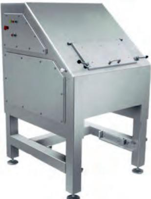
Ротор данной блокорезки представляет собой врачающийся вал с закрепленными на нем ножами П-образной формы. Конструкция данного узла имеет значительно больший запас прочности и долговечности по сравнению с аналогичными машинами других марок.
